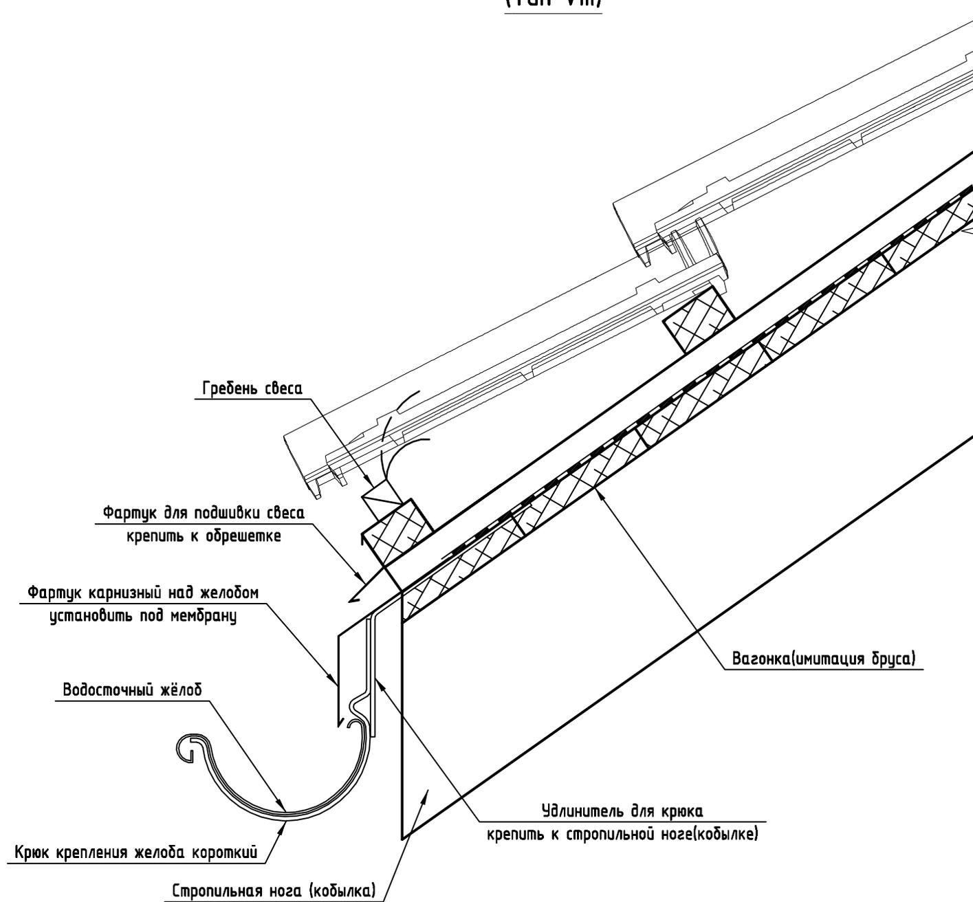
Карнизный узел для кровли с уклоном кровли <math><22^\circ</math>
