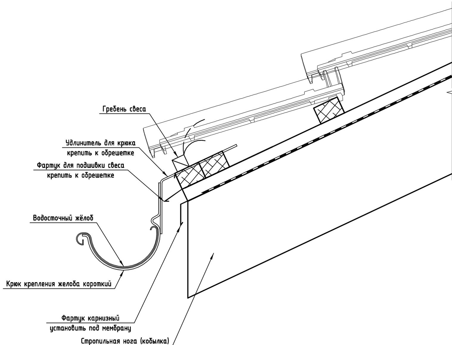
Карнизный узел для кровли с уклоном кровли 22°-30°
