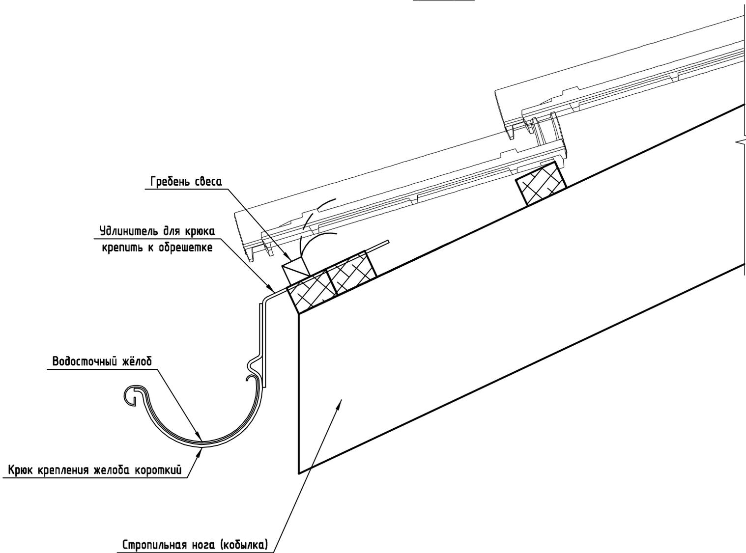
Карнизный узел для кровли с уклоном кровли >30°
