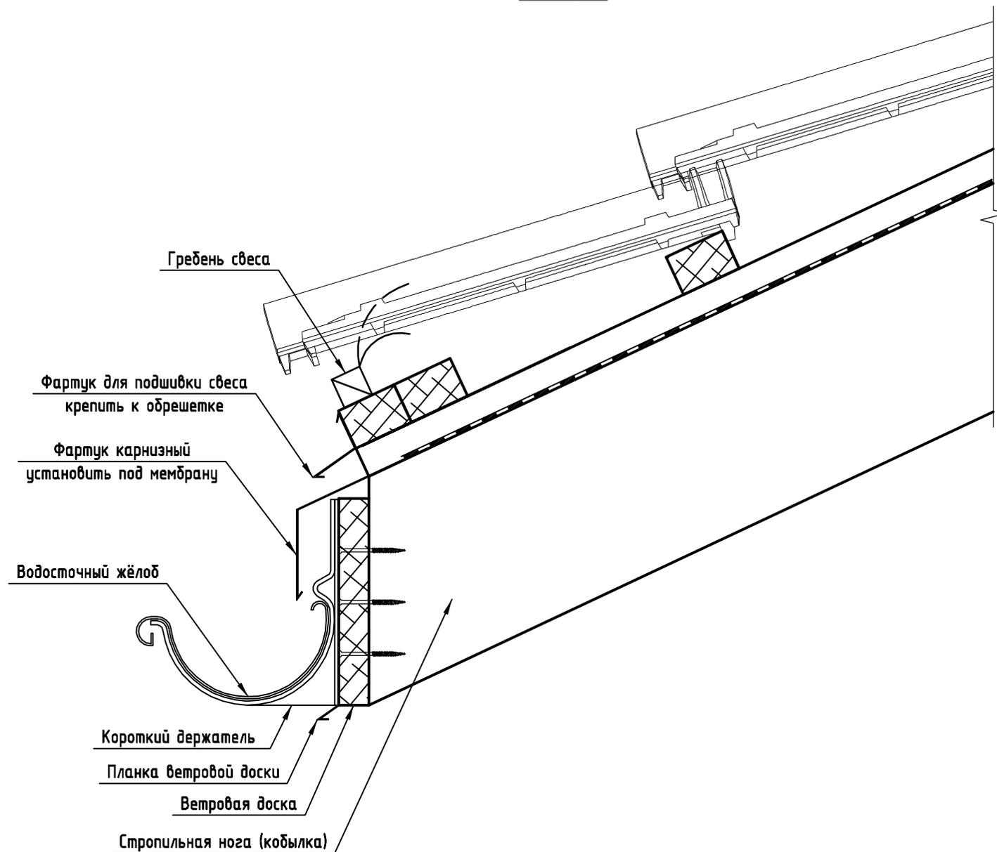
Карнизный узел для кровли с уклоном кровли 22°-30°
