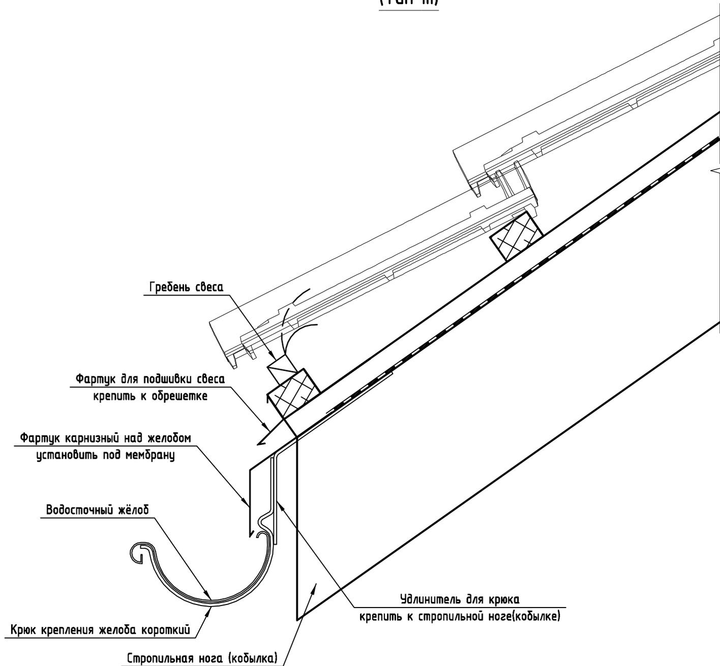
Карнизный узел для кровли с уклоном кровли 22°-30°
