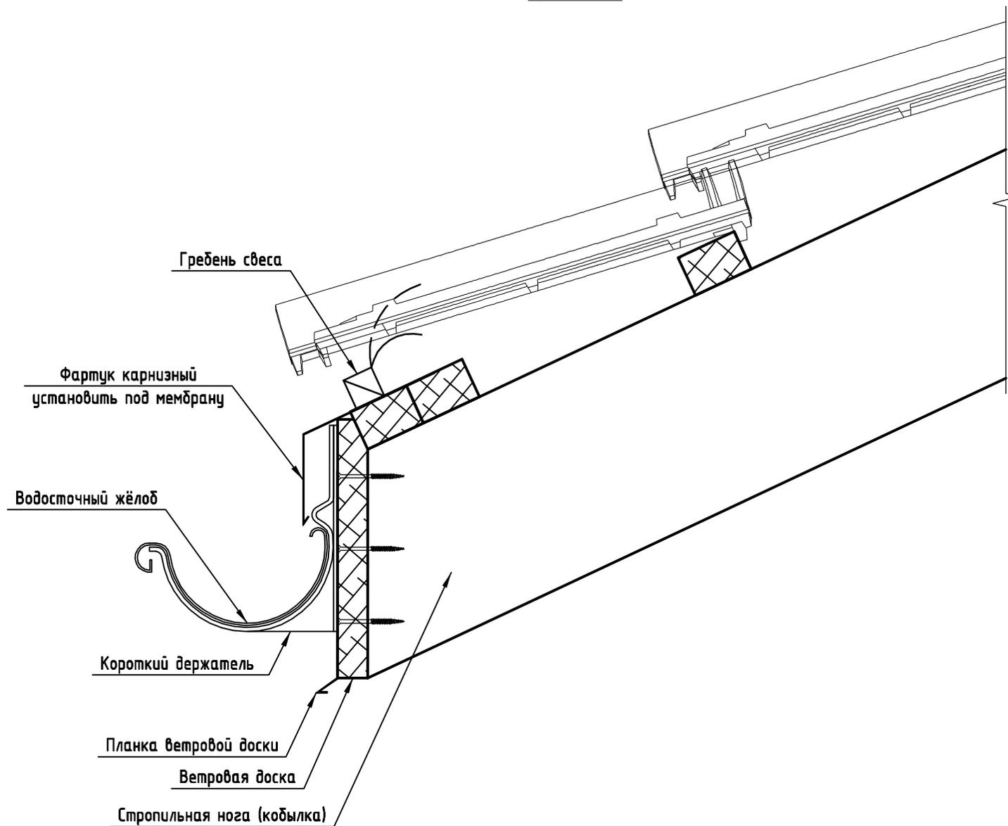
Карнизный узел для кровли с уклоном кровли 22°-30°
