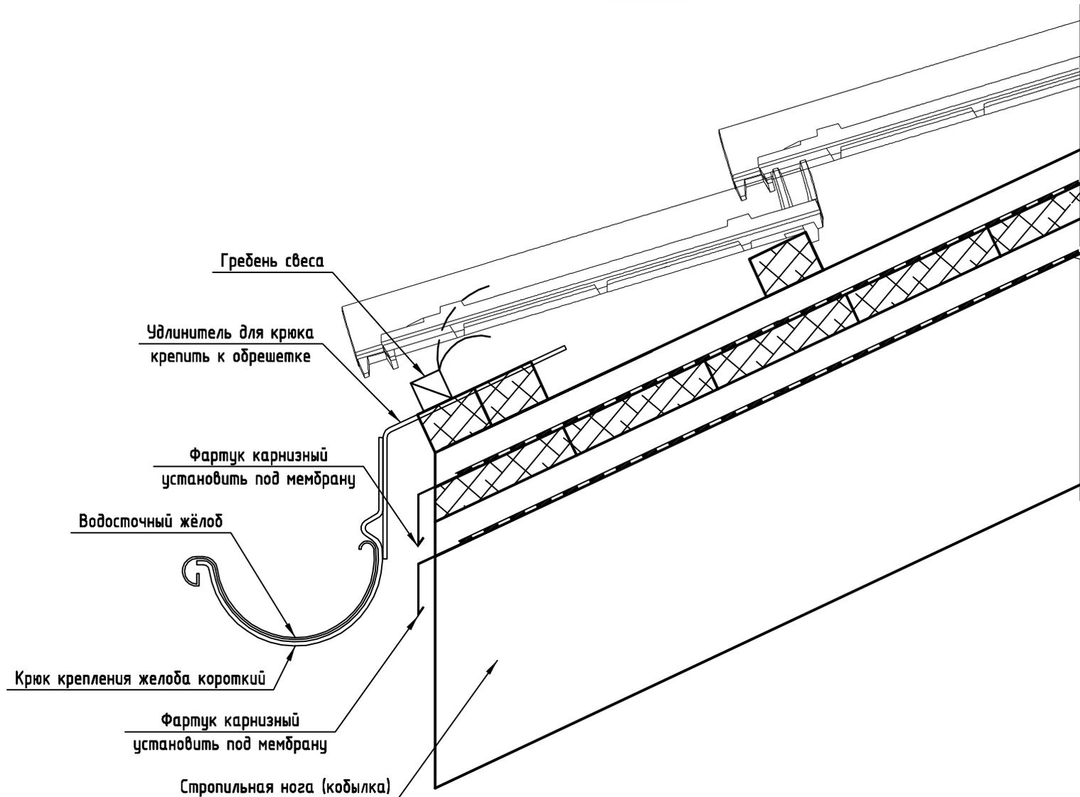
Карнизный узел для кровли с уклоном кровли <math><22^\circ</math>
